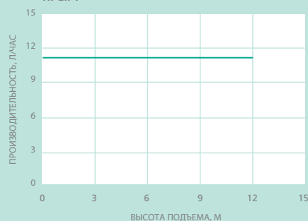
ДИАГРАММА ПРОИЗВОДИТЕЛЬНОСТИ НАСОСА HI-LIFT
